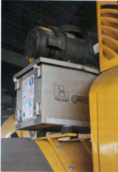
CoRRect air-System montiert auf einem Radlader.
