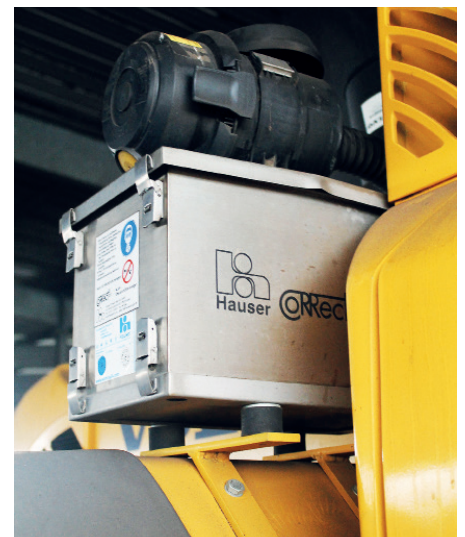
01 Schutzbelüftungssystem montiert auf einem Radlader
